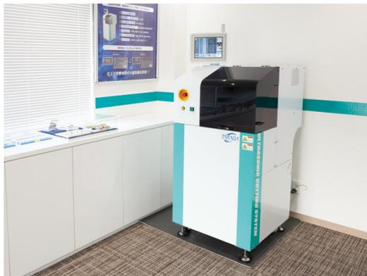
断面観察用超音波カット装置
