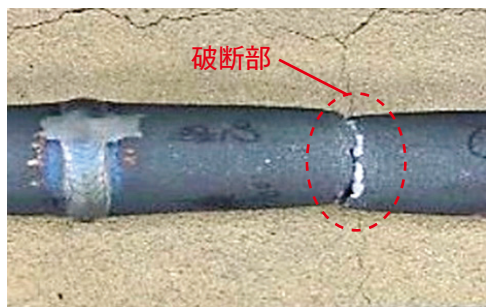
図4 引張試験片の破断部
