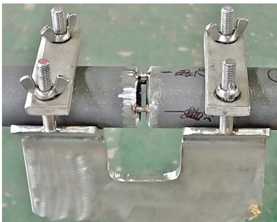
図1 配管の固定用ジグ
