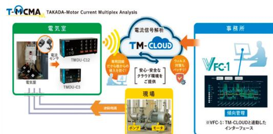
図1 回転機械の遠隔監視・診断システム
