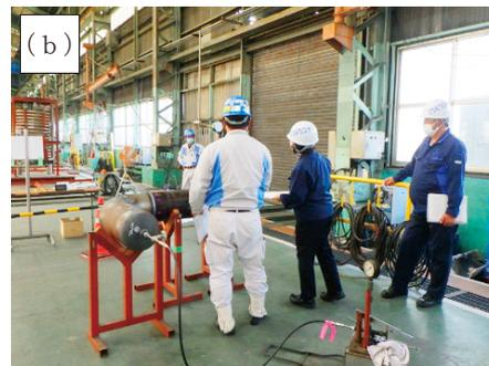
図3 本社工場審査時の様子 (a) 本社工場計測器管理状況の確認 (b) 模擬品における耐圧・漏えい試験
