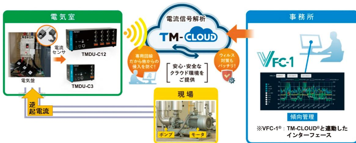
図3 電流情報量監視・診断システム
