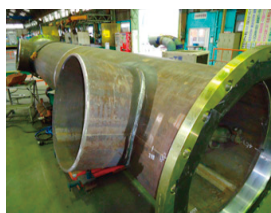
(a) 更新配管の製作
