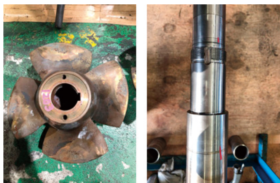
図10 C機のインペラのエロージョンとシャフト摺動痕
