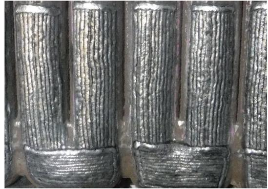
図7 肉盛補修溶接後の実機チューブ
