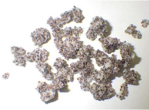
図6 スポンジブラストで使用される研掃材
