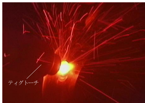
図5 窒化した部分のビードオン試験
