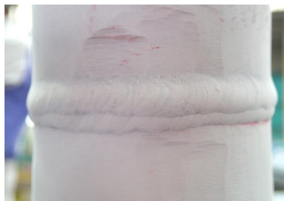
(a) 外面の浸透探傷試験の状況
