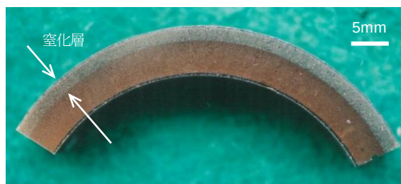
図6 窒化層を有する材料の断面マクロ組織
