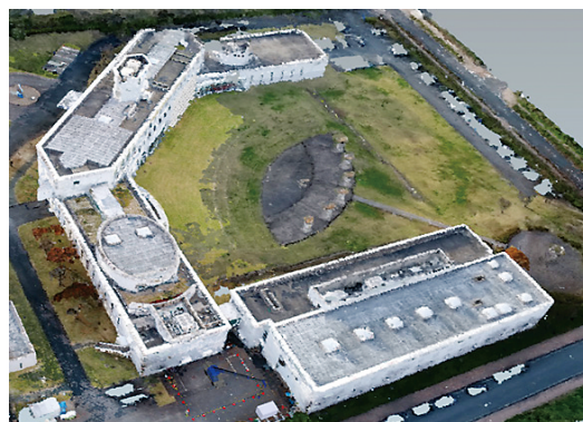
図6 ドローンによる写真データからの3Dモデル構築
