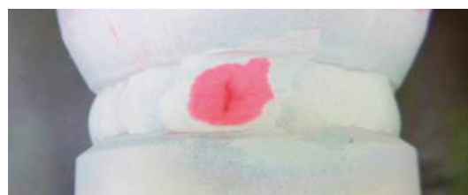
(a) 外面の横割れ
