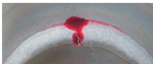
(b) 内面の横割れ
