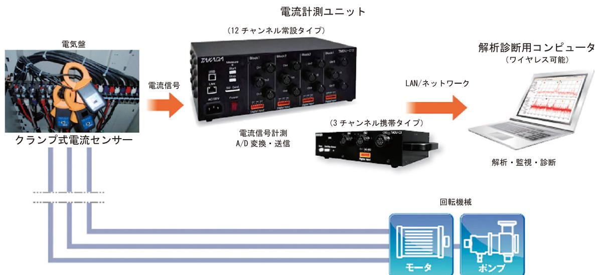
図2 電流情報量診断システム(T-MCMA)構成
