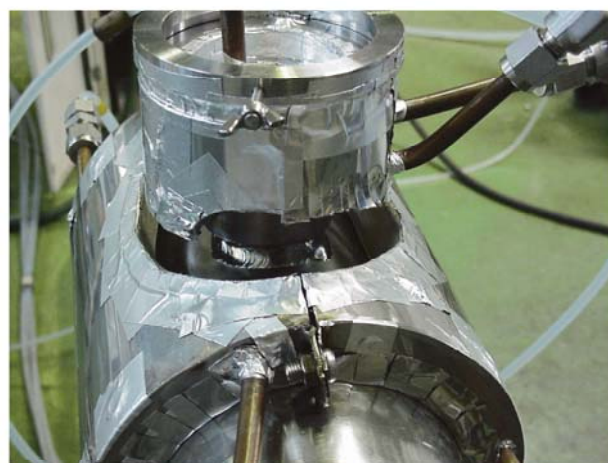
(b) ボス取付溶接
