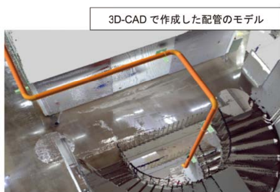
図3 点群データと3D-CADモデルの重ね合わせ
