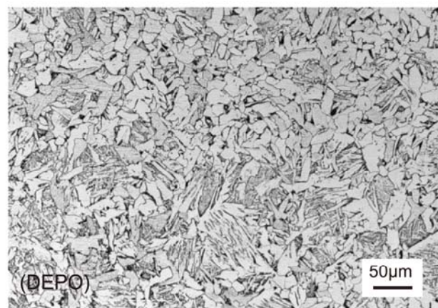
図 8 溶接部の断面マクロ組織におよぼす溶接後熱処理の影響
