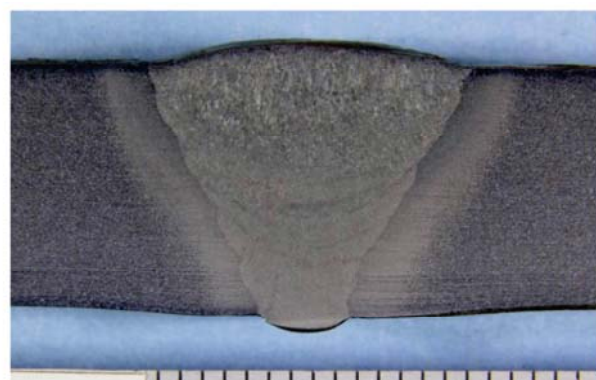
(d) 溶接後熱処理 3 回 (STPA24)
