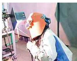
被覆アーク溶接
