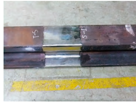
図8 溶接部仕上げ状況
