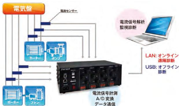
図9 電流情報量診断システム(T-MCMA)の構成
