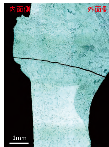
図 36 断面ミクロ組織（疲労き裂）
