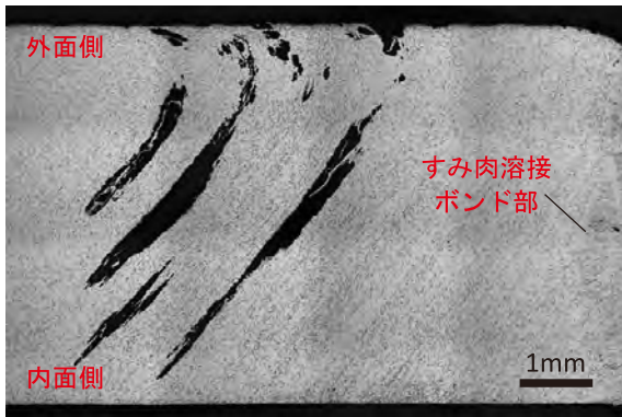
図10 断面ミクロ組織(MnSの選択腐食)
