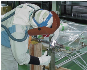
溶接 各パスの色調検査 最終層溶接 非破壊検査(RT・PT)
