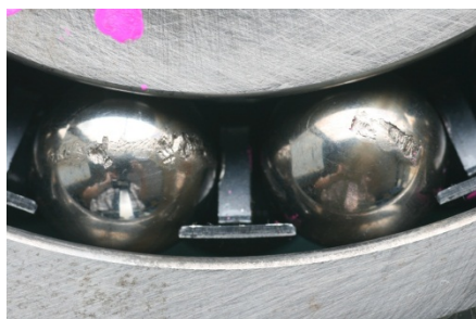
図2 ボールの損傷状況
