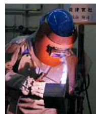
被覆アーク溶接
