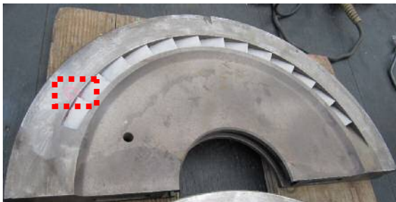
図3 上半3段仕切板 MT 割れ状のきず部
