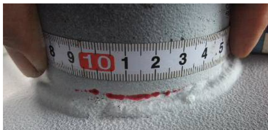
図8 低圧側インペラのボス部溶接線(止端部の割れPT)
