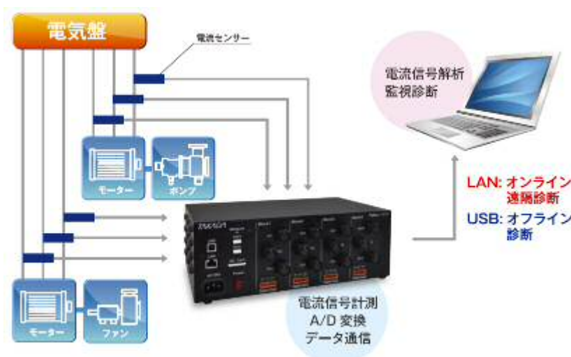
図8 電流情報量診断システム(T-MCMA)の構成
