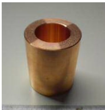
図 10 機械加工後の一次焼結品
