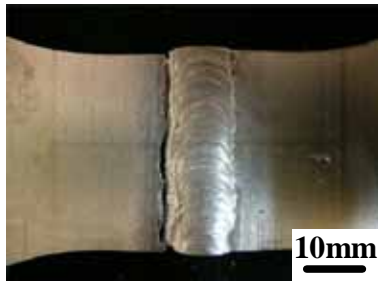
図9 AZ31/AZ31の引張試験後の試験片
