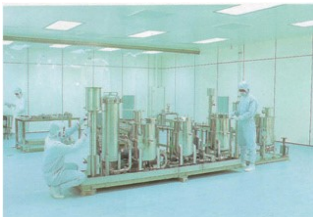
クリーンルームでのユニット組み立て
