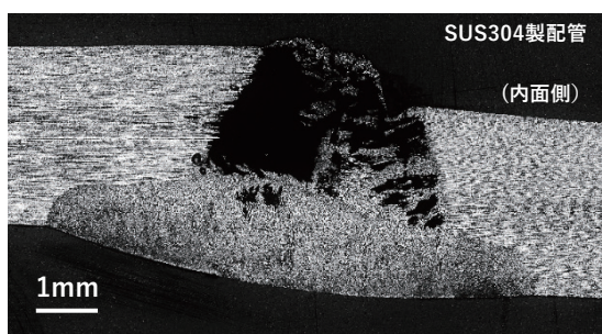
突合せ溶接部に発生したインク壺型の腐食
