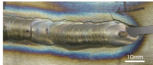
裏波ビード止端部に発生した延性低下割れ
