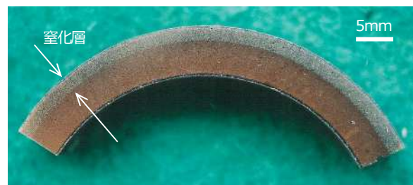
図4 窒化層を有する輻射管の断面マクロ組織
