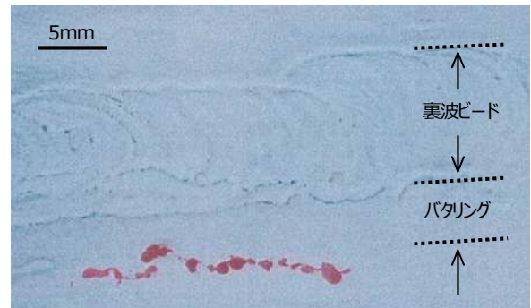
図 17 内面のバタリング溶接止端部に発生した割れ
