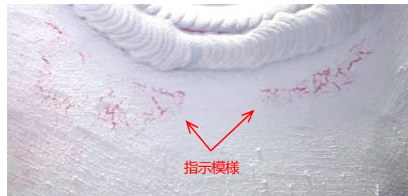
図2 輻射管の溶接後における浸透探傷試験の状況
